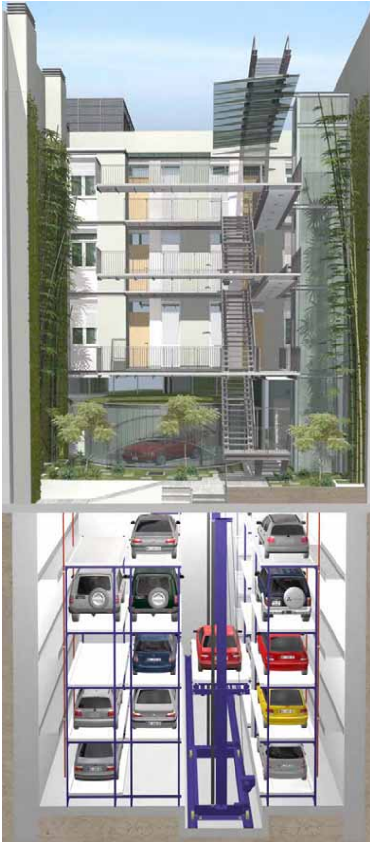
Figura 17. Construcción de un aparcamiento robotizado con 55 plazas bajo un edificio de nueva planta en el casco histórico. C/ Huertas 39, Madrid.
