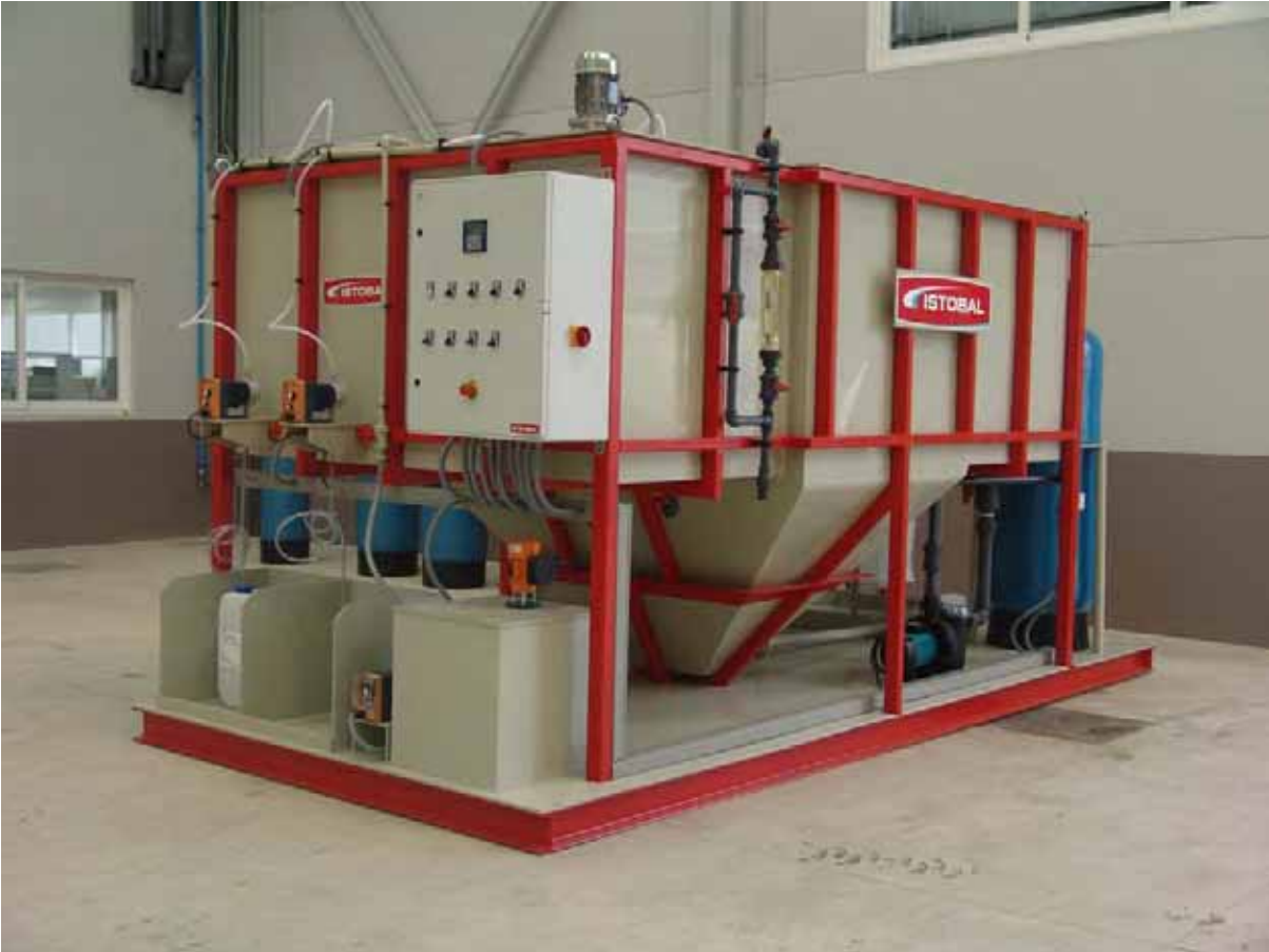
Foto 7. Depuradora físico-química de 5 m 3 /hora.
