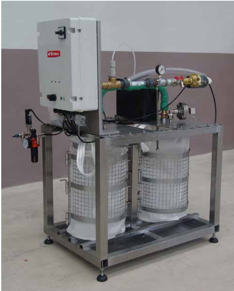
Foto 6. Deshidratador de lodos.
