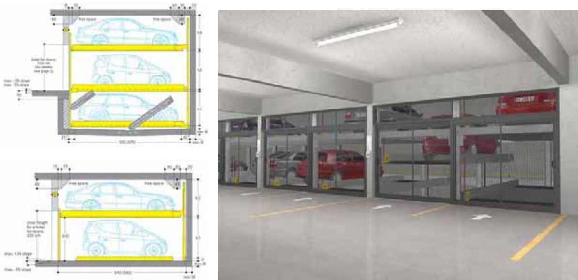
Figura 6. Esquemas y vista del sistema Combilift .
